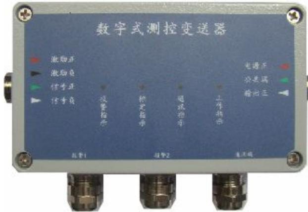
数字式测控变送器是本公司全力打造的一款全新的测控设备。其能够实现将称重传感器的模拟信号，RS232或RS485 数字信号转换为标准的模拟量信号以及开关量继而控制输出，可以方便地与PLC 等工控设备进行连接配套。
